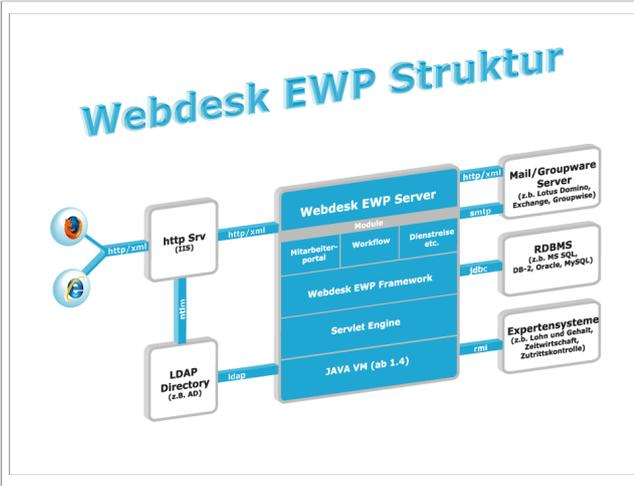
Webdesk EWP ist ein Entwicklungsframework mit integrierter Prozess-Engine, welche modular entsprechend den Funktionsanforderungen eingesetzt wird.
