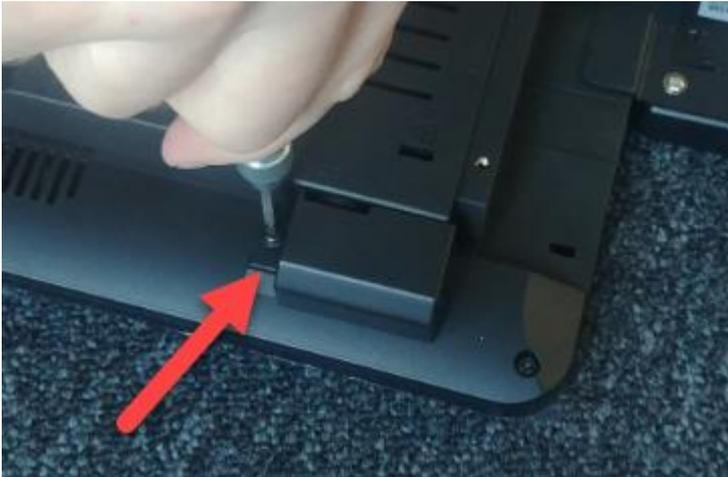
Verbinden Sie dann das Stromkabel mit dem Terminal
